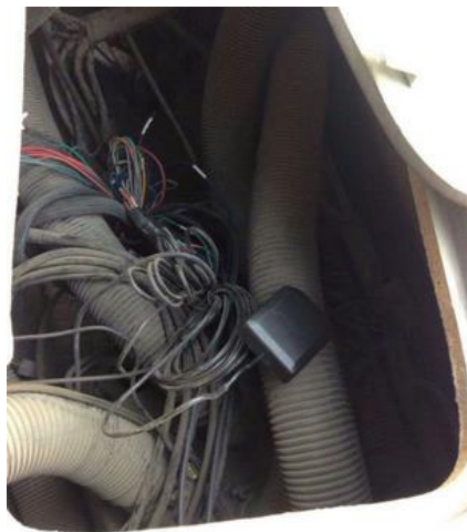
天线放在排气管上（容易发热），也没固定
